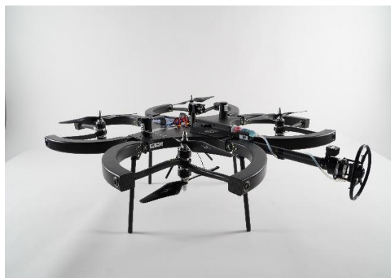
Skygauge 社の非破壊検査用ドローン
