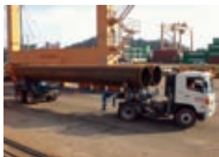
塗装工場へ搬送される素管
