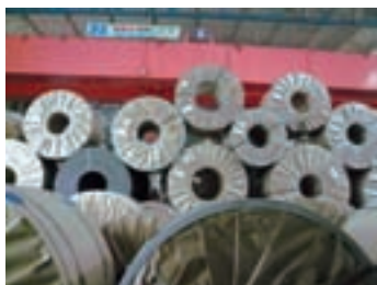
加工前のコイル（鋼板をロール上にしたもの）
