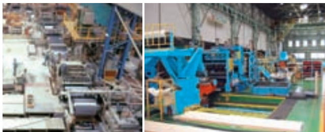
コイルを希望に応じて必要なサイズ幅にカットするスリッターライン
